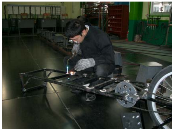
足回りは廃材のLアングル
